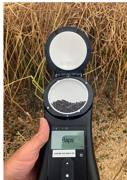
En svårighet kan vara att få till rätt provmängd. Blir provet för stort eller för litet måste mätaren tömmas och kalibrering och mätning göras om på nytt. Foto: Fredrik Tidström
